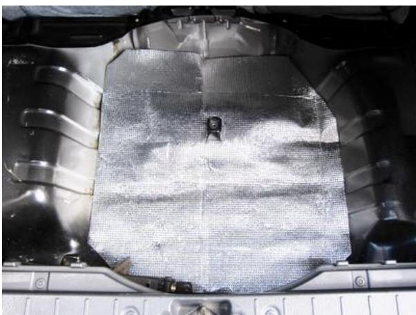
スペアタイヤを収納してた部分が、吸音の為かアスファルト系のシートが貼られてたので、荷物が汚れないようにシートを切り出しました。
